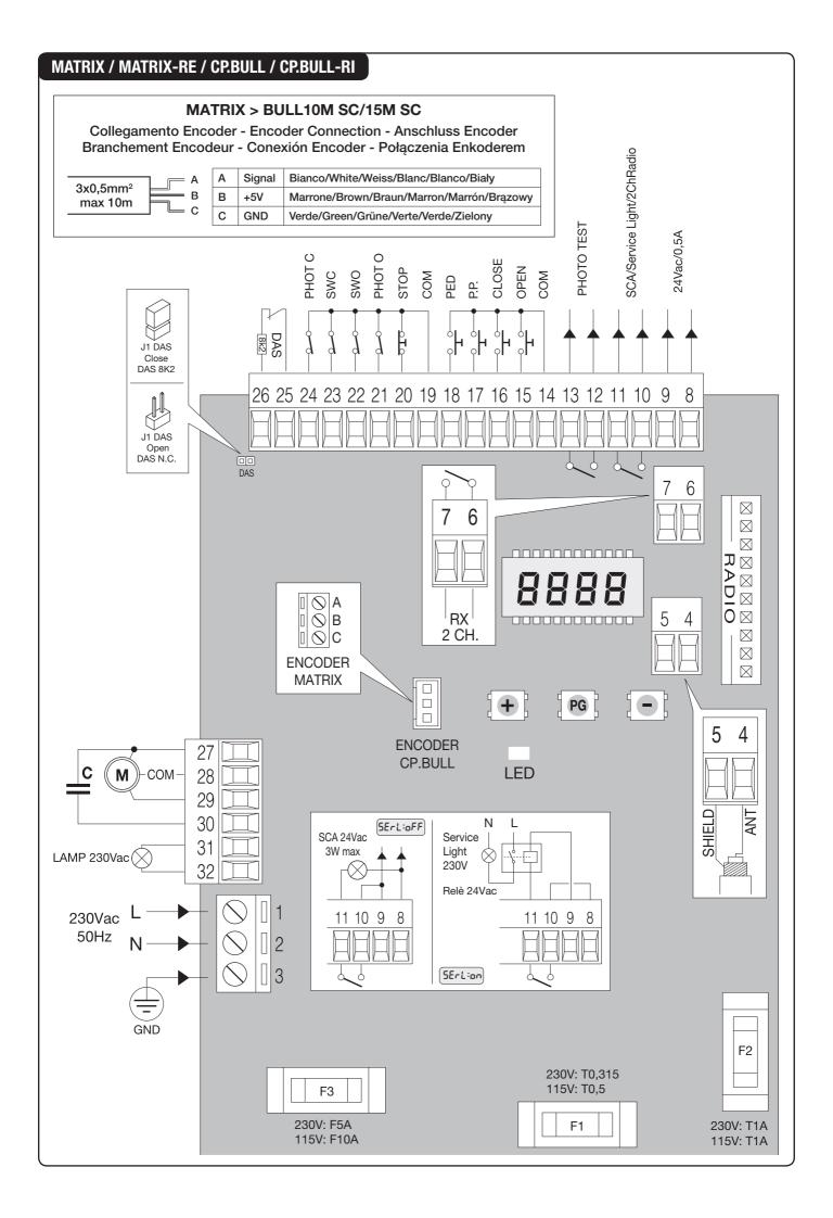
Collegamento dispositivi di sicurezza verificati / Connection of tested safety devices
